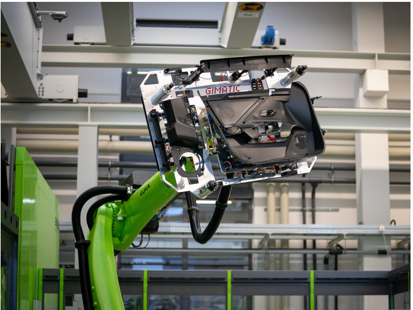
Drei auf einen Streich: Ein Sechssachsroboter entnimmt die fertig gespritzte Baugruppe, die aus Türverkleidung, Kartentasche und Brüstung besteht.
