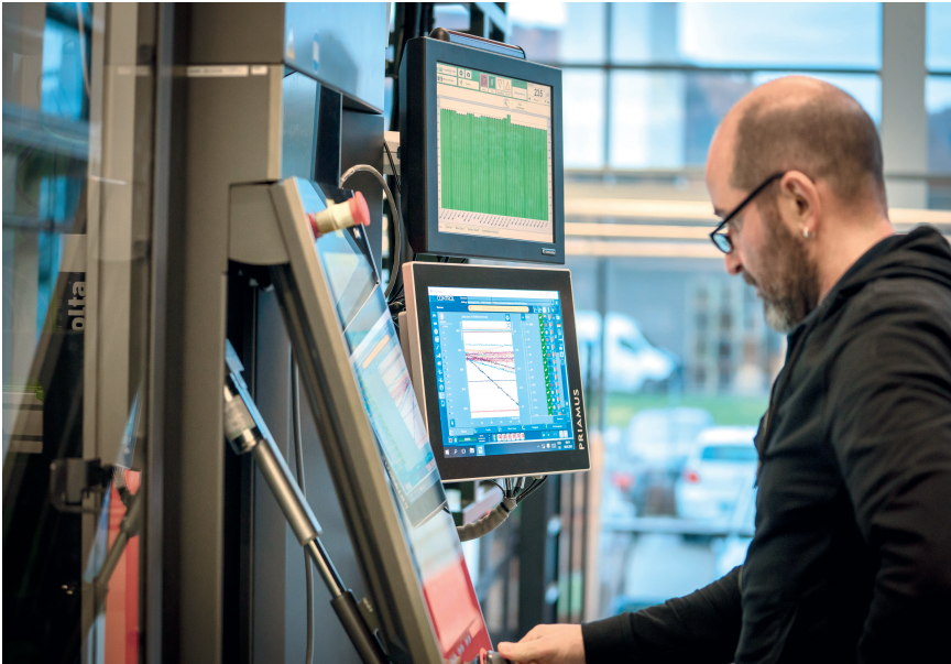
Bild 5. Die DynamicFeed-Technologie ermöglicht eine individuelle Schmelzedruckregelung in Echtzeit. © Fobooha / Christoph Raetzke
